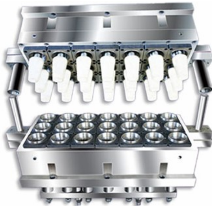
Figura 13.5 – À esquerda, o ferramental para termoformação de copos por vácuo, com pré-estiramento por plugue. A ferramenta inferior é o molde com 21 cavidades por vácuo. Em cima, a placa de alojamento dos plugues para estiramento. À direita, dois plugues de epóxi em destaque.
