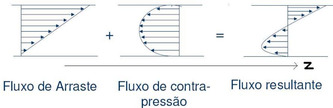
Figura 38. Perfis de velocidade para um fluido Newtoniano.
