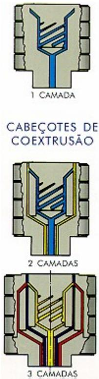
**Figura 76** - Matrizes do tipo espiral para extrusão de filmes tubulares
