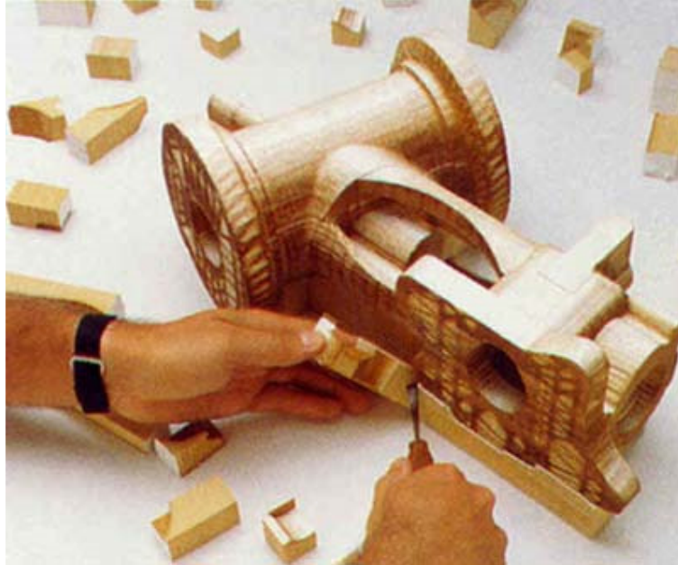
Protótipo obtido por LOM - www.peridotinc.com
