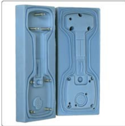
Molde obtido por Direct AIM - www.techok.com
