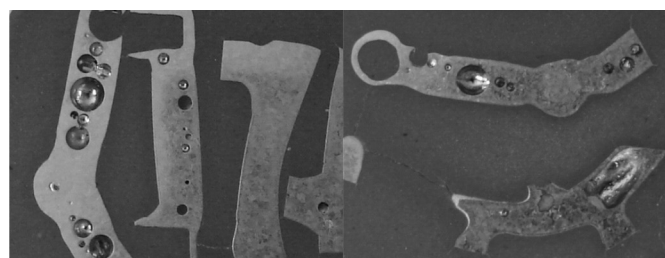
Figura 3. Corpos de prova 2 e 3 com bolhas (esféricas) e vazios.
