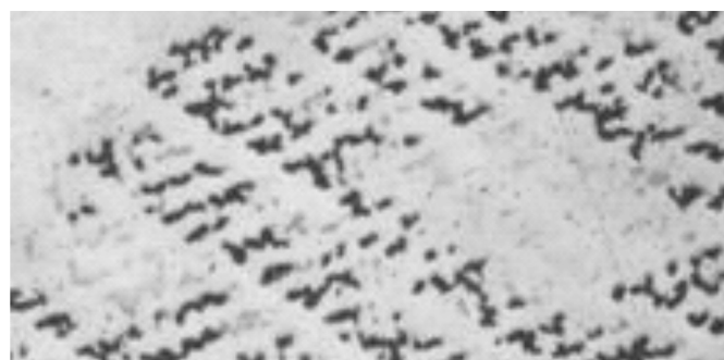
Figura 2. Corpo de prova - pastilha de Co-Cr atacada por Kroll – 100X.
