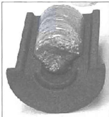
Figura 3.5 – Amostra de FGMMC produzida por fundição centrífuga no forno de centrifugação Titanacast 700 \mu P Vac. A amostra encontra-se alojada no interior de uma das metades do molde de grafite, cuja entrada se encontra voltada para o observador.
